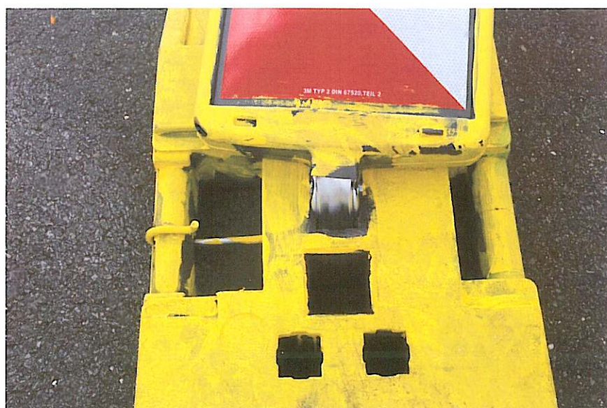
Abb. 6: Leitbake 2 nach der Anfahrt. Die Leitbakensysteme wurden in verriegeltem Zustand geprüft.
